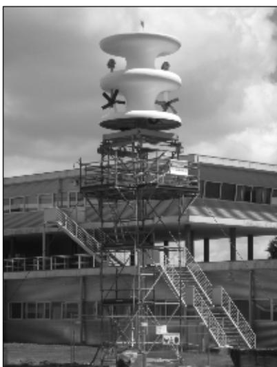
**Prototype éolienne WindCap installé à l'Enib.**
