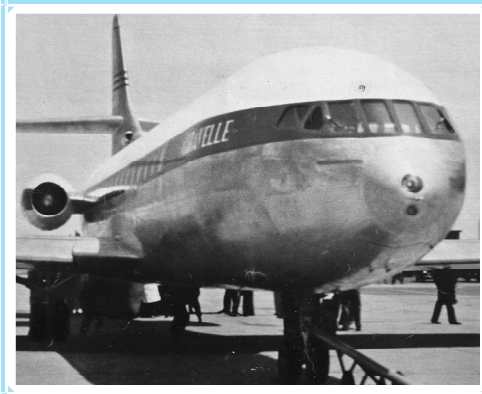
La Caravelle équipé à l'arrière de réacteurs Avon de 4500 kg de poussée.
