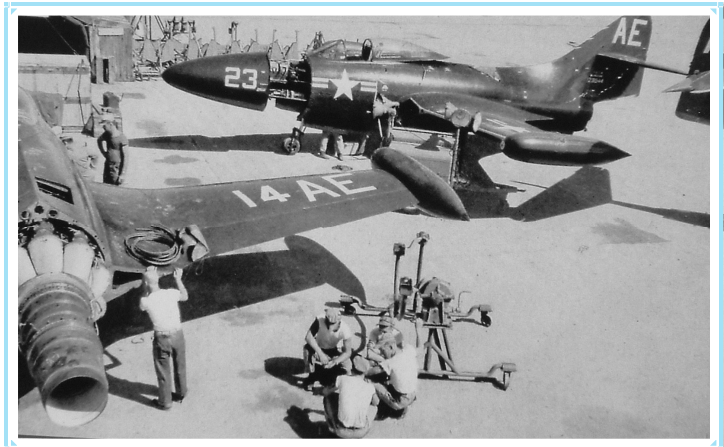
Le Panther en Corée et son moteur J 42 de 2500 kg de poussée.
